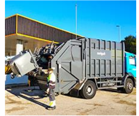
Càrrega i buidat de contenidor
