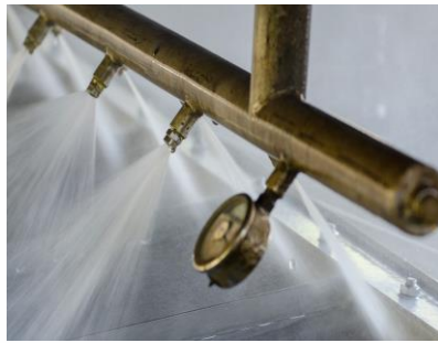
Neteja a pressió de la malla del filtre
