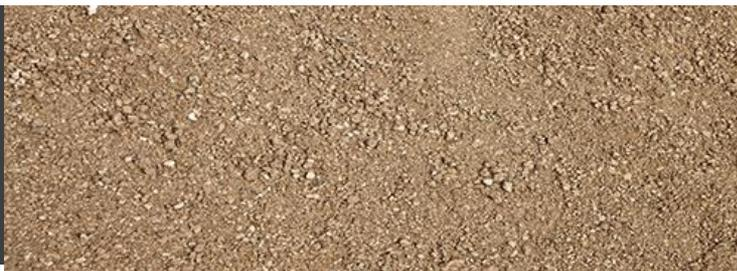
Árido fino sometido a proceso de clasificación; con una composición granítica y fruto de la meteorización, de textura regular y homogénea y un contenido muy bajo en finos, así como un alto equivalente de arena.
