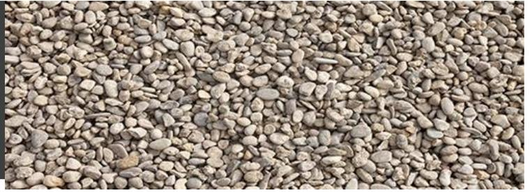
Árido grueso sometido a proceso de doble lavado y clasificación; con una composición básicamente silíceo, de forma redondeada y un nulo contenido tanto en finos como en materia orgánica.
