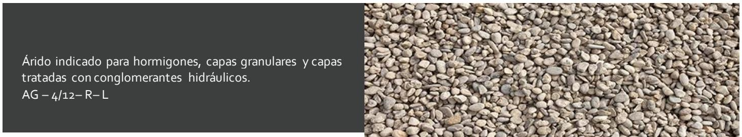
Árido indicado para hormigones, capas granulares y capas tratadas con conglomerantes hidráulicos.
