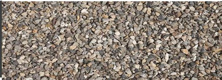
Árido grueso sometido a proceso de trituración, clasificación y lavado; con una composición básicamente silíceo, de forma cúbica y con una excepcional resistencia tanto al pulimento como a la fragmentación.
