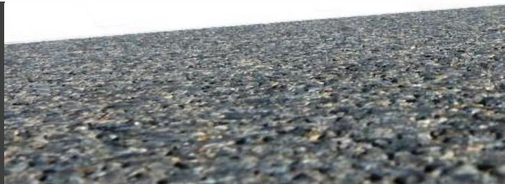
Los áridos porfídicos se caracterizan por tener unas propiedades físicas y mecánicas muy particulares que los hacen de gran interés para su utilización en capas de rodadura en la ejecución de carreteras de altas prestaciones.
