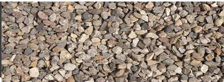
Árido muy grueso sometido a proceso de trituración y clasificación; con una composición básicamente silíceo, de forma cúbica y con una excepcional resistencia tanto al pulimento como a la fragmentación.
