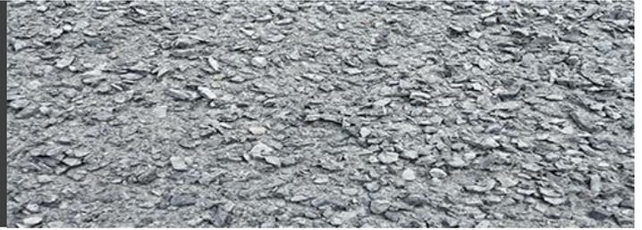
**Arena TERC. (T-0/5).** Los áridos porfídicos de nuestra compañía se caracterizan por tener unas propiedades físicas y mecánicas muy particulares, que los hacen de gran interés para su utilización en capas de rodadura en la ejecución de carreteras de altas prestaciones.
