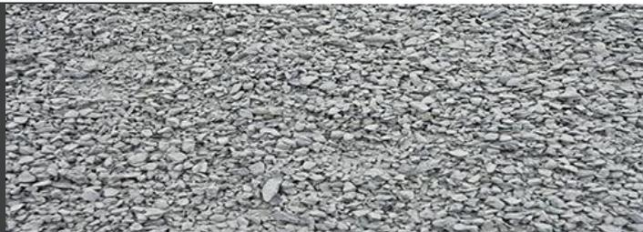
Arena SEC. (T-0/5). Los áridos porfídicos de nuestra empresa se caracterizan por tener unas propiedades físicas y mecánicas muy particulares, que los hacen de gran interés para su utilización en capas de rodadura en la ejecución de carreteras.
