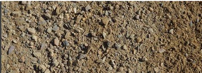
**Arena artificial (T-0/5).** La arena artificial se consigue por medio de la trituración de fracciones más grandes de árido natural de origen poligénico de la gravera de El Corb y su posterior cribado.
