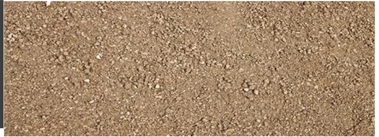
Árido muy fino sometido a proceso de trituración y clasificación; con una composición básicamente silíceo, de textura regular y homogénea, y un contenido muy bajo en finos, así como un alto equivalente de arena.
