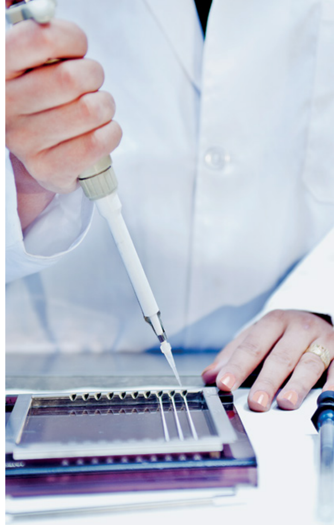
Preparació de mostra per a la separació de components de lligants bituminosos mitjançant cromatografia. FOTO: Sònia Tapiolas.
